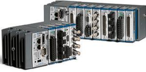
CompactRIO 将开放嵌入式架构与小巧、坚固以及 C 系列模块进行了完美融合，是一种由 NI LabVIEW 驱动的可重配置 I/O (RIO) 架构。每个系统包含一个 FPGA，用于自定义定时、触发以及处理一系列可用的模块化 I/O，可满足任何嵌入式应用程序的需求。
